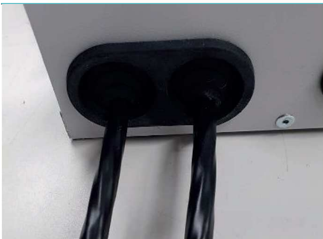
Inserire la guarnizione nella sede ovale e accertarsi della sua perfetta aderenza ai bordi.
