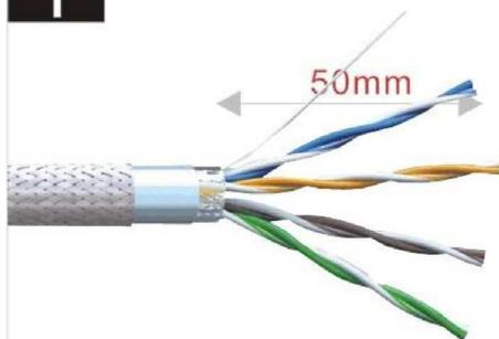
Preparare, rimuovendo la sola guaina esterna, circa 50 mm di cavo, portando a nudo le coppie e la relativa schermatura, indifferentemente di tipo U/FTP, F/UTP o X/FTP.
