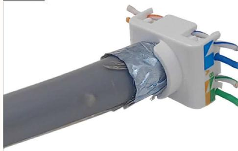
Inserire la dima sulla testa del cavo, ed una volta sbindate le coppie, inserirle nelle apposite fenditure in base alla codifica scelta, lasciando sporgere l'eccedenza, ed avendo cura di non forzare gli incroci dei conduttori
